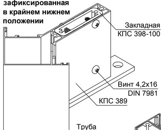
Нижний узел крепления стоек без применения закладных деталей (В качестве верхнего узла крепления не применяется)
