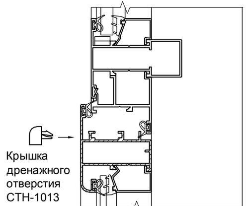
**Выполнение дренажных отверстий в нижних перекладинах створок КПС 199 под установку крышки дренажного отверстия СТН-1013**
