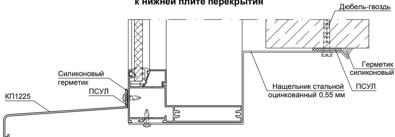
Примыкание навесного вентилируемого фасада системы СИАЛ П-Г-Пл к
