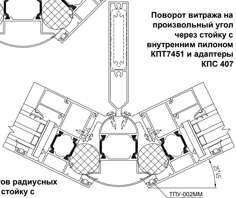
Организация заворотов радиусных витражей через одну стойку с помощью закладной КПС 272, замена вертикальных штапиков на примере заполнения 31 мм
